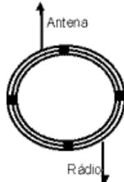
Um método simples de construção do BALUM 1:1, é utilizando-se o próprio coaxial que será ligado do Rádio até a antena, enrolando-o e fazendo uma bobina, que dependendo do número de voltas, o resultado será o acoplamento para uma determinada frequência ou multibanda, ou seja, para um grupo de frequências em HF, que ressonará em todas as faixas.
